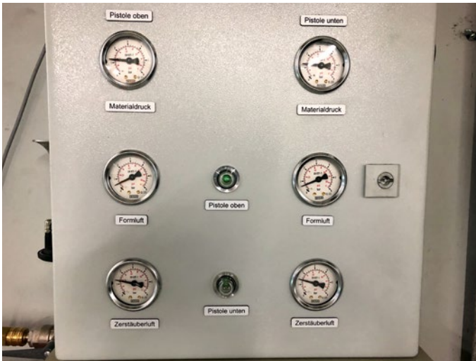
Über den Druckluftversorgungsschrank werden zentral und von außen die Zerstäuber- und Formluft der elektrostatischen Automatikpistolen sowie die Spritzmaterialmengen eingestellt.
