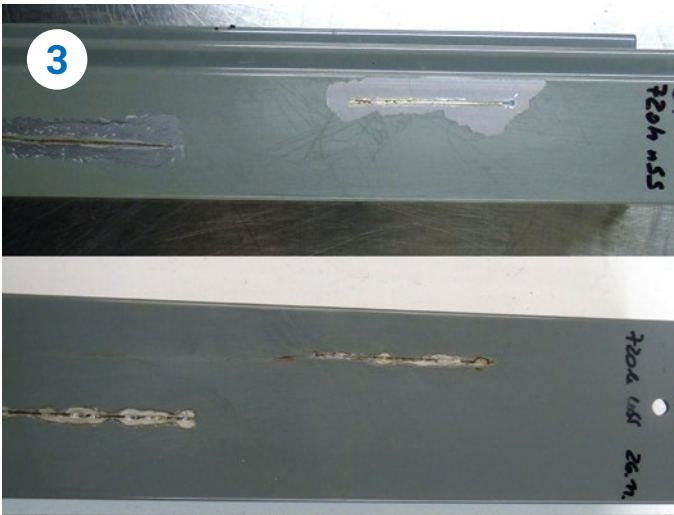
3 Abb. 3: Große Unterschiede stellte das Labor bei der Lackunterwanderung am Ritz aufgrund unterschiedlicher Vorbehandlung (nach 720 h nSS-Test) fest; oben: zu starke Beizentfettung + Eisenphosphatierung; unten: alkalische Entfettung + Zinkphosphatierung.
