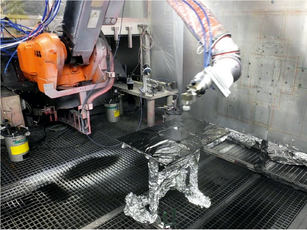
Bild 2: Zur Bewertung der Haftfestigkeit werden die Proben nach dem Beflammen im Lackiertechnikum automatisch lackiert.
