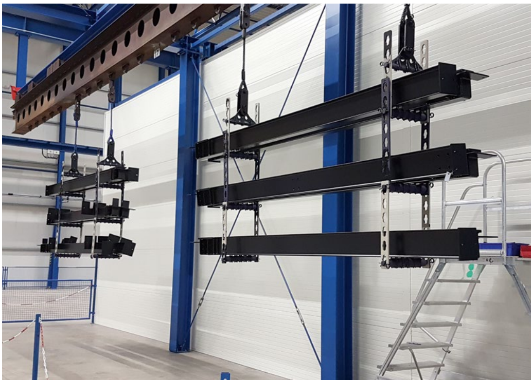
Für den Durchlauf der Stahlträger hat der Lohnbeschichter spezielle Warenträger entwickelt. Foto: Giga Coating
