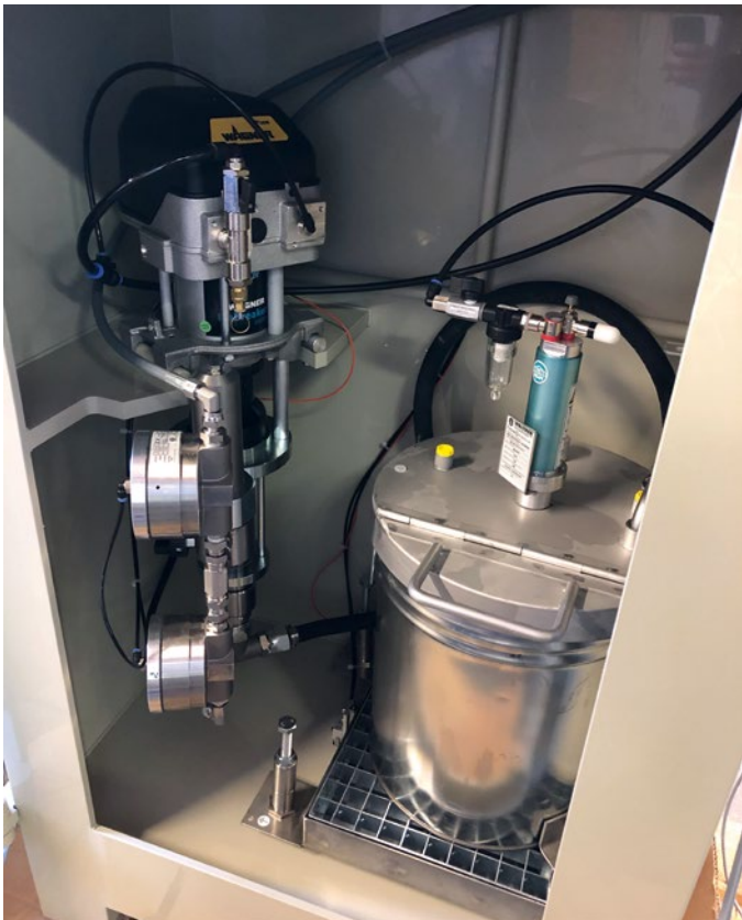
Die „AquaCoat 5010“-Automatikanlage gehören eine Förderpumpe und ein Hobbockdeckel mit Druckluftgetrieberührwerk. Fotos: Wagner
