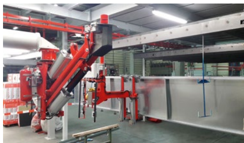
Mit dem Gelenkarm-Manipulator lassen sich Arbeitsabläufe ergonomisch gestalten. Foto: Zeilhofer
