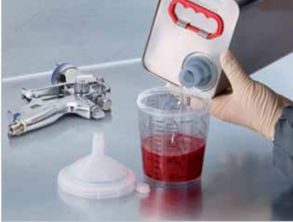
Anmischen von Lack erfolgt in dem Becher, mit dem anschließend lackiert wird.
