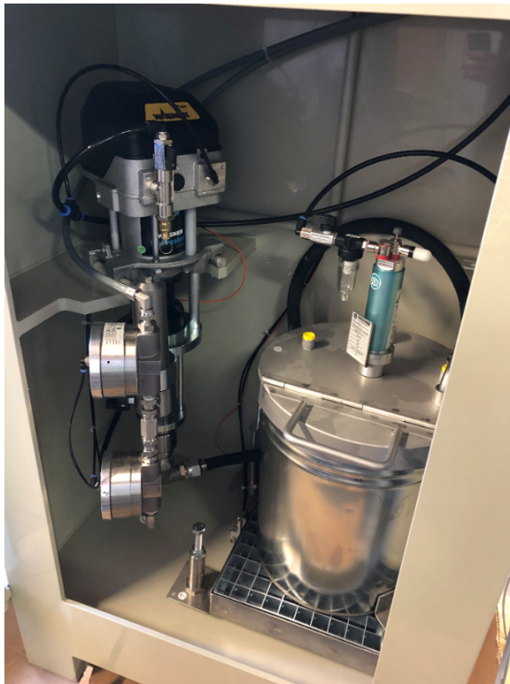
Links: Innenansicht der AquaCoat 5010 Automatanlage mit Förderpumpe und Hobbockdeckel mit Druckluftgetrieberührwerk
